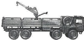
69 LKW 10 t mit beweglichem Kran Camion M.A.N. 10 to avec grue M.A.N. 10 to truck with crane
